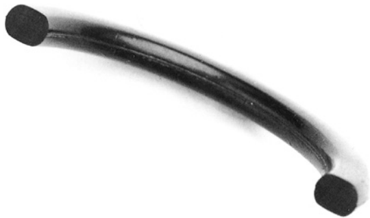
Bild 10.8 Schadensbild durch hohe bleibende Verformung (Compression Set)
