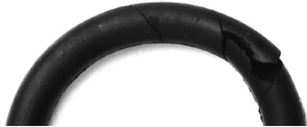
Bild 10.10 Verdrehter O-Ring mit Einschnitten in der O-Ring-Oberfläche
