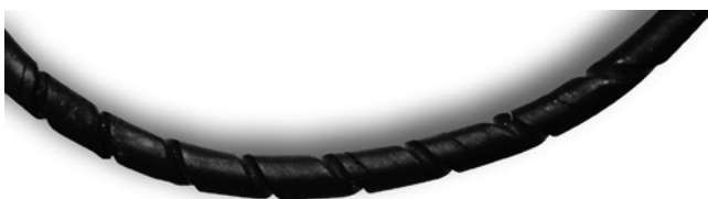
Bild 10.9 Verdrehter O-Ring mit spiralförmigen Markierungen
